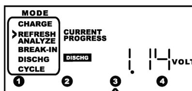
**Remarque:** les valeurs obtenues par un voltmètre ne correspondent pas avec celles du chargeur car un voltmètre ne pourra pas mesurer la tension (V) pendant la charge ou la décharge.
