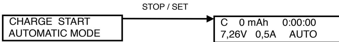
L'intelli-Control commence immédiatement à charger l'accu. Dans les 3 premières minutes l'accu sera mesuré avec précision (l'intensité varie) et l'intensité correcte sera appliquée. L'intensité sera réglée de façon telle à ce que la charge soit la plus soignée tout en étant la plus rapide possible.
